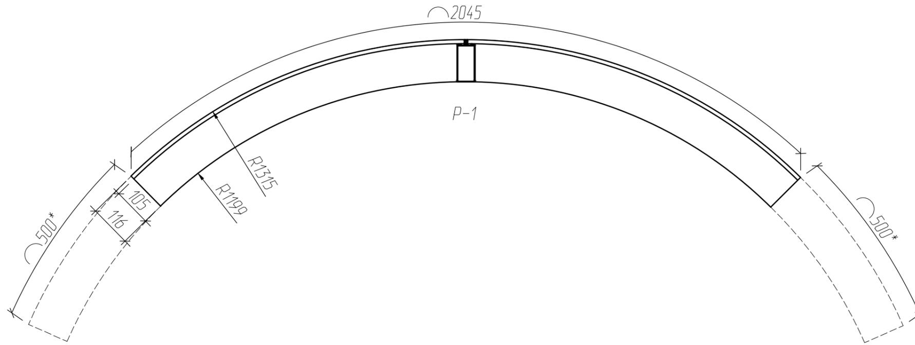
Схема гибки прижимного профиля АЛЮТЕХ F50.0624F
